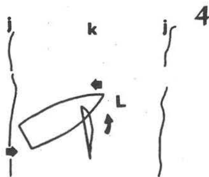
obr. 4 Obrácené proudy na hřebenu a v brázdě podporují otáčení. J – hřeben, k – brázda. L – kroucí moment.
